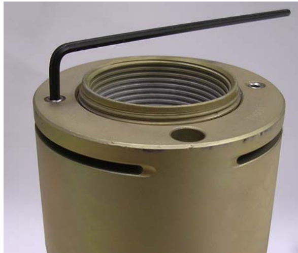
Fotografía de ejemplo del aflojamiento de los tornillos opresores de una tuerca
